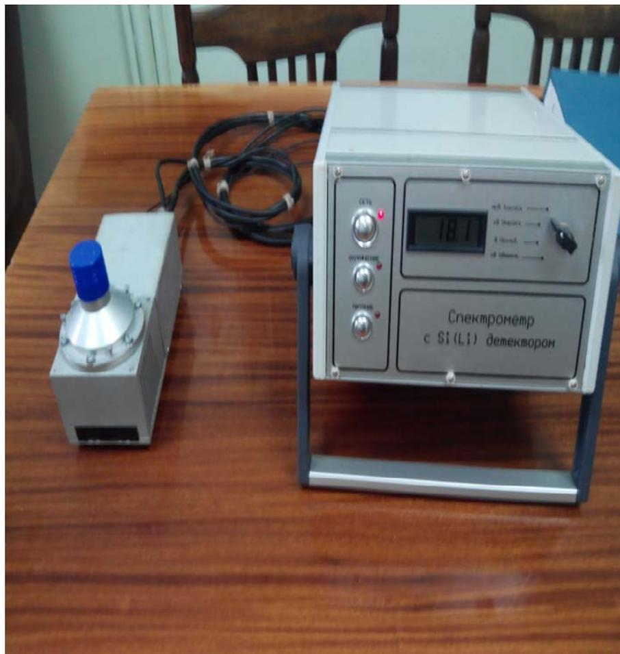
Блоки детектирования разработаны на основе Si(Li) и p-i-n CdTe детекторов и обеспечивают эффективную регистрацию рентгеновского излучения с энергией до 150 кэВ. Разрешение составляет 200 эВ для Si(Li) детектора и 500 эВ для CdTe детекторе. Охлаждение детекторов производится миниатюрными термоэлектрическими охладителями.
