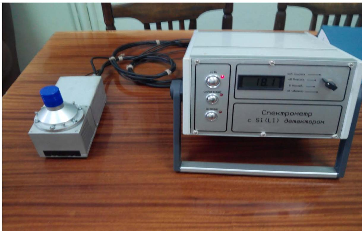
Блок с  $\text{Si}(\text{Li})$  детектором изготовлен и испытан для экспериментов по Мёссбауэровской спектроскопии в лаборатории нейтронных физико-химических исследований.
