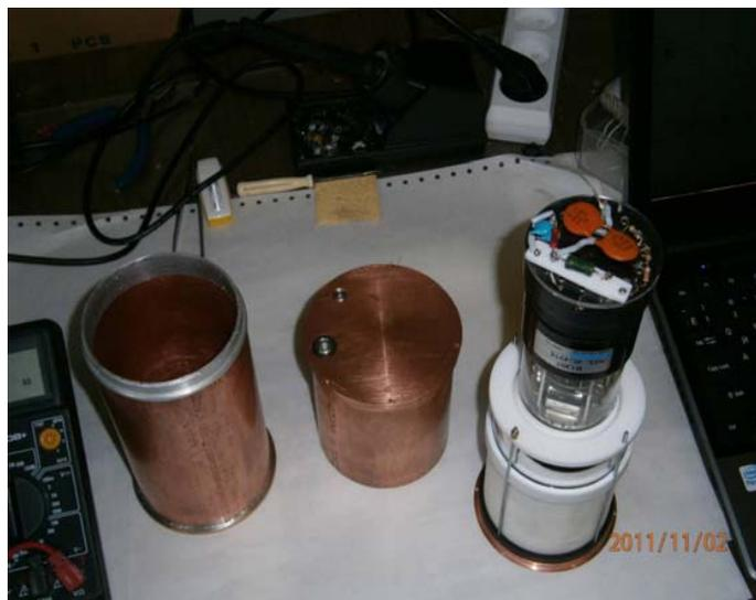
1. В установке использовались сцинтилляционный BGO детектор. Кристалл из ортогерманата висмута **2.5 кг  $Bi_3Ge_4O_{12}$**  был изготовлен в виде цилиндра высотой **76 мм** и диаметром **76 мм**.
