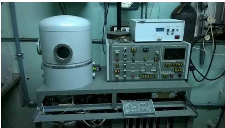
установка для напыления слоев аморфного Si (ПИАФ)
