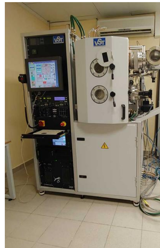
установка для напыления слоев AlN (СПБГУ)
